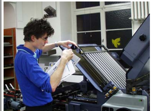
Abb. 6: Einstellen einer Falztasche in der Buchbinderei. Der Bogendurchlauf in der Falzmaschine ist Grundlage für das Ausschließen der Druckbogen.
